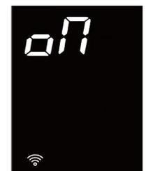
Appuyez sur **+** ou **-** pour passer d'un mode à l'autre. Sélectionnez "oN" pour activer et "oF" pour désactiver. (Le réglage par défaut est oN).
